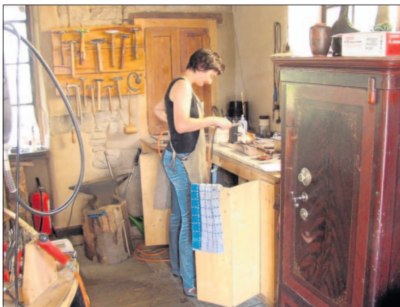
Mit einem Brenner wird das Silber immer wieder gegläht, damit es sich leichter schmieden lässt. Rechts von RHEINPFALZ-Redakteurin Anke Herbert ein Tresor von 1890, der aus einem Neustadter Nachlass stammt.
