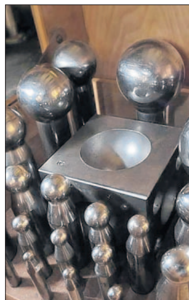
Keine Kegel zum Bowlen, sondern ebenfalls Werkzeug. Der runde Kopf prägt das Silber beim Hämmern.
